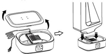
1. Снимите нижнюю крышку и выньте кабель питания.
