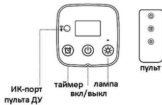
Нажмите кнопку «Вкл./Выкл.», чтобы последовательно переключаться между режимами «низкая скорость ветер», «высокая скорость ветра» и «режим ожидания».
