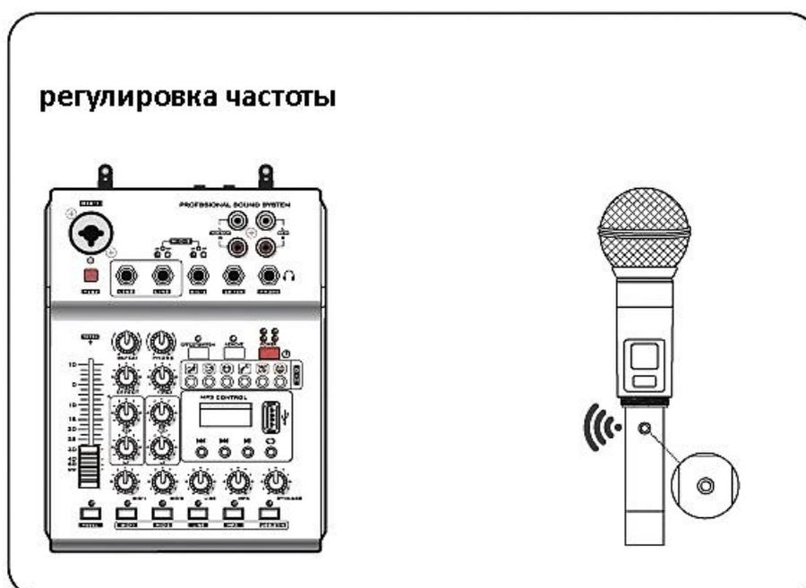
Когда микшер и ручной микрофон настроены на хорошую частоту, нажмите клавишу частоты ручного микрофона, частота ручного микрофона изменится, частота микшера также изменится.
