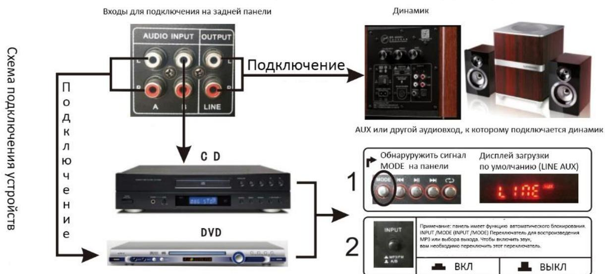
Примечание: когда телевизор необходимо подключить к этому устройству, проверьте, есть ли (АУДИО ВЫХОД) или (АУДИО выход) на панели телевизора. Именно он используется для подключения.
