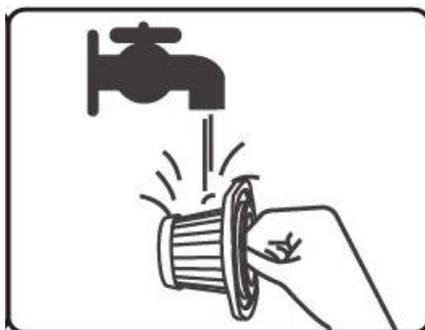
3. При необходимости очистите пылесборник влажной тканью или одноразовым бумажным полотенцем. Сетку фильтра можно мыть водой. После промывания его необходимо полностью высушить, а затем можно использовать снова.
