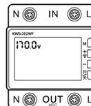
3. Настройка защиты от перегруза напряжения нажмите M еще раз, чтобы отобразилось 0.000 А. Нажмите «+» для регулировки (1/1 В). Нажмите один раз, чтобы добавить или вычесть 0.001 В, удерживайте, чтобы быстро добавить или вычесть, выключено по умолчанию.
