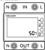
8. Настройка режима гистерезиса экрана. Нажмите еще раз M, чтобы отображилось 000. Нажмите +- для регулировки (шаг в 1 минуту). Нажмите один раз, чтобы добавить или вычесть 1 минуту, удерживайте, чтобы быстро добавить или вычесть.
