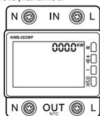
7. Настройка защиты от перегрева. Нажмите еще раз M, чтобы отображилось 50°. Нажмите +- для регулировки (шаг в 10 Вт). Нажмите один раз, чтобы добавить или вычесть 1°, удерживайте, чтобы быстро добавить или вычесть, значение по умолчанию 50°.
