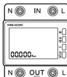
6. Настройка защиты от перегруза питания. Нажмите еще раз M, чтобы отображилось 0 Вт. Нажмите +- для регулировки (шаг в 10 Вт). Нажмите один раз, чтобы добавить или вычесть 0,1 Вт, удерживайте, чтобы быстро добавить или вычесть, значение по умолчанию 0.
