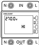
2. Настройка защиты от падения напряжения нажмите M еще раз, чтобы отобразилось 170,0 ВLO. Нажмите «+» для регулировки (1/1 В). Нажмите один раз, чтобы добавить или вычесть 1 В, удерживайте, чтобы быстро добавить или вычесть, значение по умолчанию 170,0 В.
