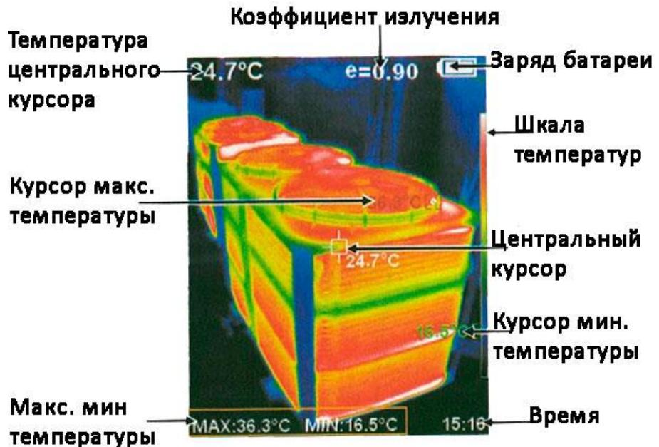
Цветовой код используется, чтобы обозначить относительную температуру от низкой к высокой в поле зрения объектива
