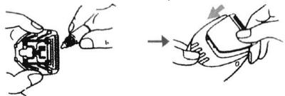
4. После очистки нанесите немного смазочного масла на лезвие, затем установите лезвие на место. Вы услышите щелчок, подтверждающий, что лезвие успешно установлено.
