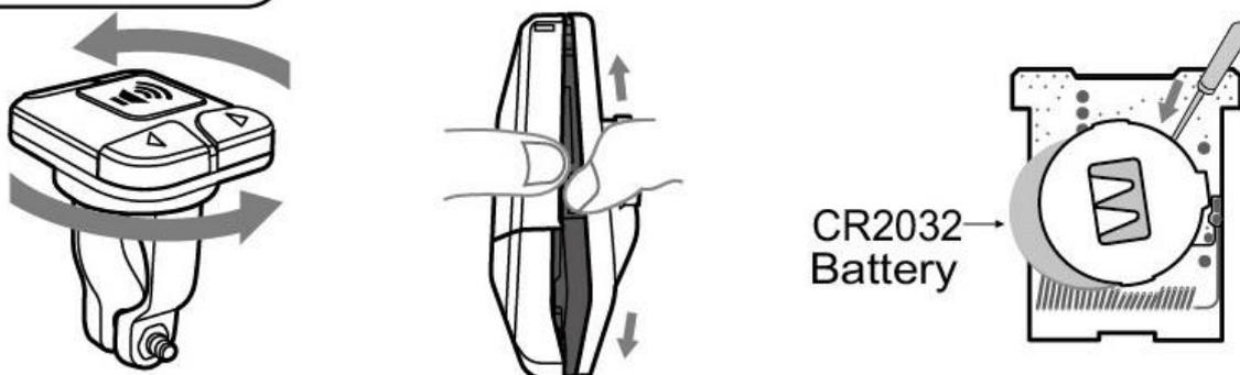
Поверните пульт по часовой стрелке/против часовой стрелки и выньте его из крепления.
