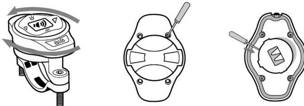
Поверните пульт по часовой стрелке/против часовой стрелки и выньте его из крепления.
