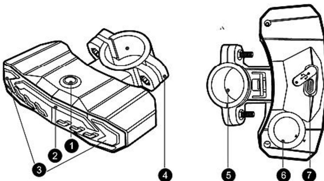
1. Кнопка режима освещения/кнопка сопряжения
